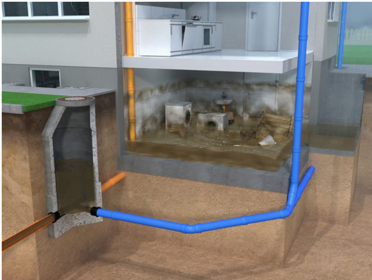
bei fehlender Rückstausicherung
